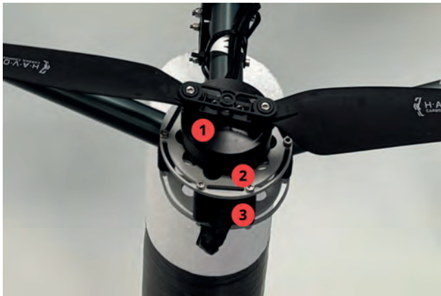
Rys. 8. Oznaczenia: (1) Silnik, (2) Podstawa mocująca, (3) Łącznik ramienia zamontowany na pojeździe Fig. 8. Labels: (1) Motor, (2) Mounting base, (3) Arm connector mounted on the vehicle
