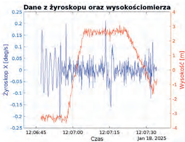
Rys. 13. Charakterystyka danych z żyroskopu w osi X oraz barometrów podczas startu z wody Fig. 13. Gyroscope data characteristics in the X-axis and barometer data during water take-off
