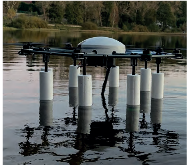
Rys. 9. BSP „SHAD” podczas wykonywania pomiarów sonarem Fig. 9. UAV „SHAD” during sonar measurement operations
