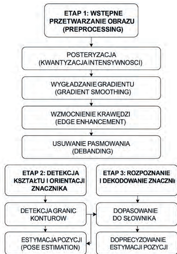
Rys. 2. Diagram opisujący etapy procesu rozpoznawania znaczników ArUco
