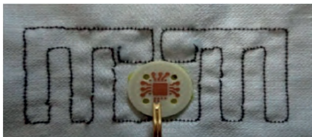
Rys. 2. Identyfikator RFIDtex Fig. 2. RFIDtex tag
