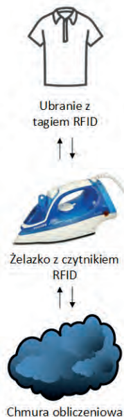
Rys. 4. Komunikacja między danymi w ubraniach a chmurą obliczeniową Fig. 4. Communication between wearable data and cloud computing
