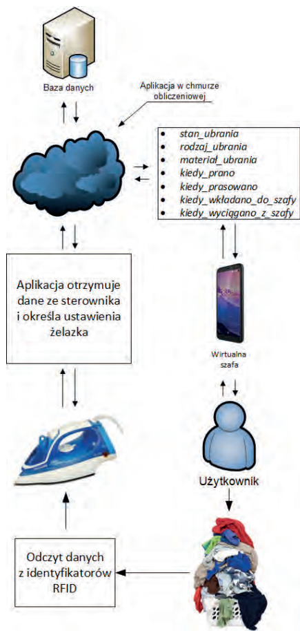
Rys. 3. Koncepcja wykorzystania żelazka z systemem RFID zintegrowanego z Internetem w Przemśle Tekstylnym Fig. 3. The concept of using an RFID-enabled iron integrated with the Internet of Things in Textile Industry
