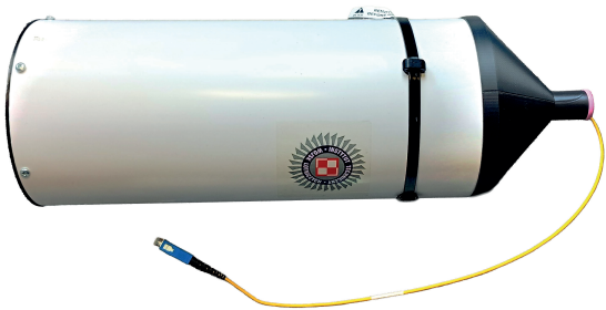
Rys. 4. Zasobnik ze światłowodem podwieszanym pod BSP Fig. 4. Container with optical fiber suspended under the UAV
