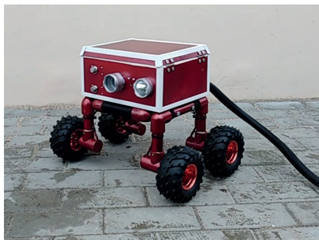
Rys. 1. Prototyp pierwszej wersji robota inspekcyjnego Fig. 1. The prototype of the first version of the inspection robot
