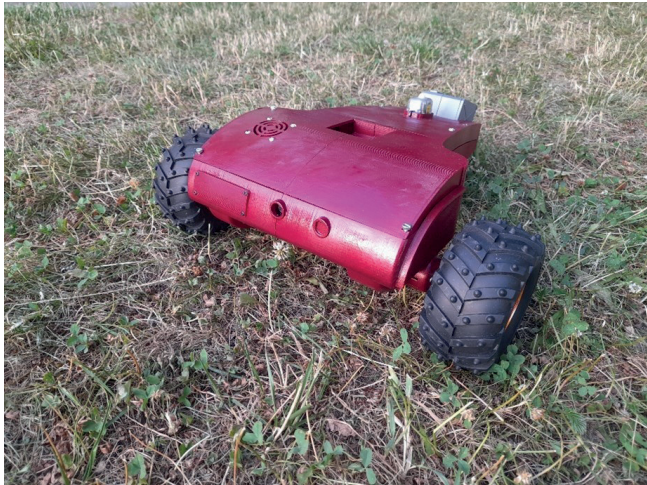
Rys. 2. Prototyp drugiej wersji robota inspekcyjnego Fig. 2. Prototype of the second version of the inspection robot
