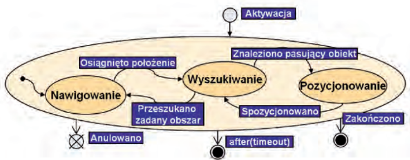
Rys. 5. Schemat przedstawiający wykonanie usługi update-Map Fig. 5. UpdateMap service realization schema
