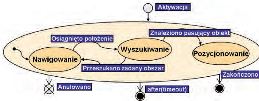
Rys. 4. Schemat przedstawiający wykonanie usługi search Fig. 4. Search service realization schema
