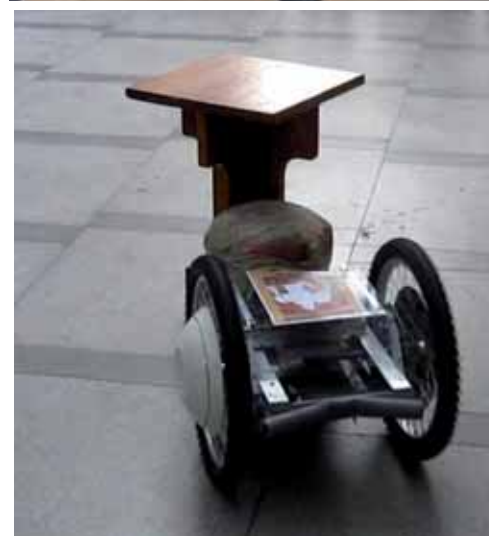
Rys. 12. Robot pchający obiekty o masie zbliżonej do jego własnej Fig. 12. Robot pushing obstacles
