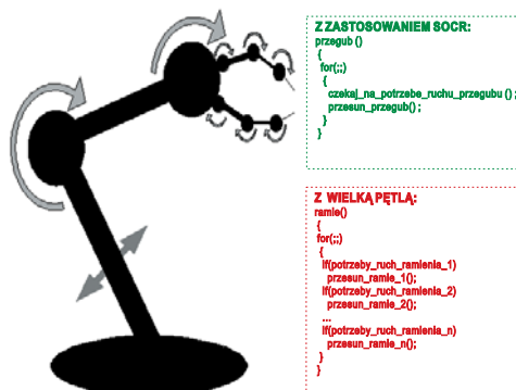
Rys. 1. Porównanie metod programowania za pomocą dużej pętli i z użyciem SOCR
