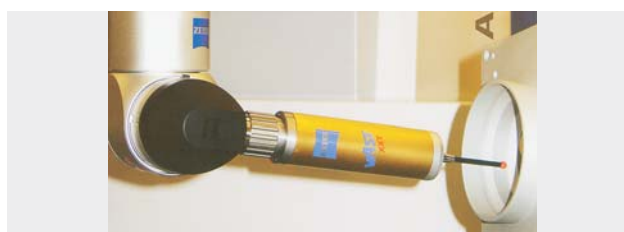
Rys. 12. Pasywna głowica skaningowa VAST XXT firmy C. Zeiss
