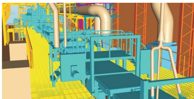
Rys. 2. Fragment wirtualnego modelu zautomatyzowanej linii wytwarzania waty szklanej
