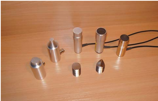
Rys. 6. Różne typy głowic ultradźwiękowych „na sucho”
