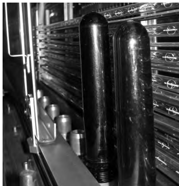
Rys. 1. Widok wnętrza zespołu ogrzewającego preformy
