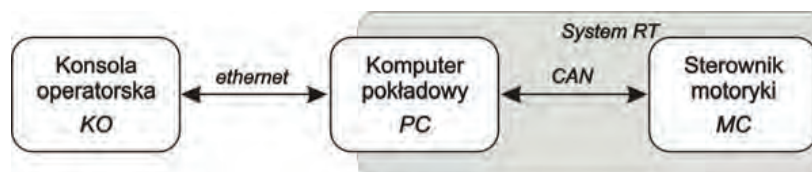
Rys. 3. Architektura klient-serwer — schemat blokowy
