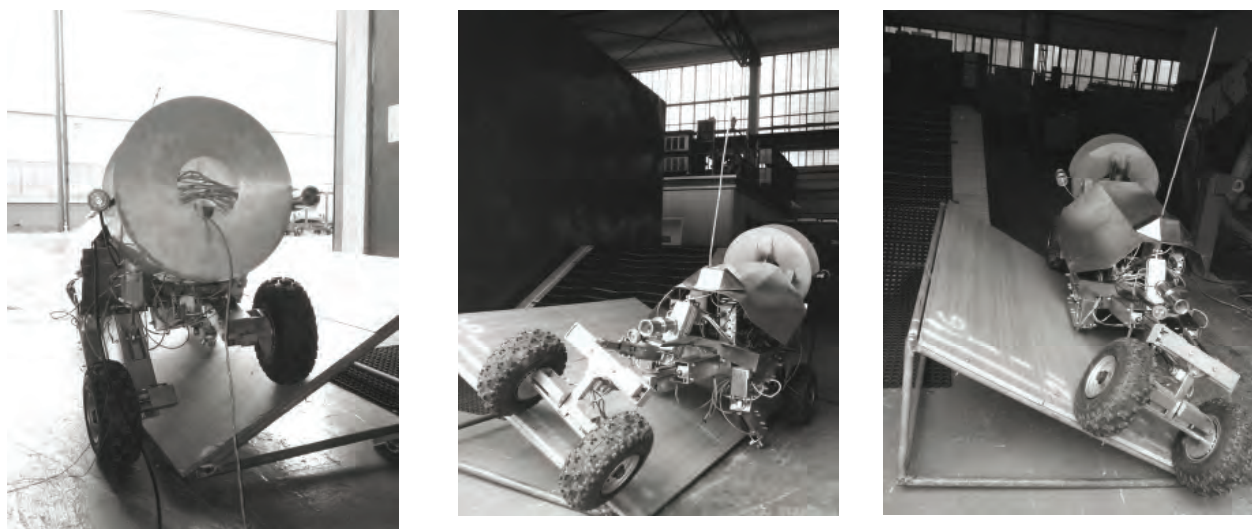
Rys. 8. Przejazd przez boczną rampę o nachyleniu 30^\circ
