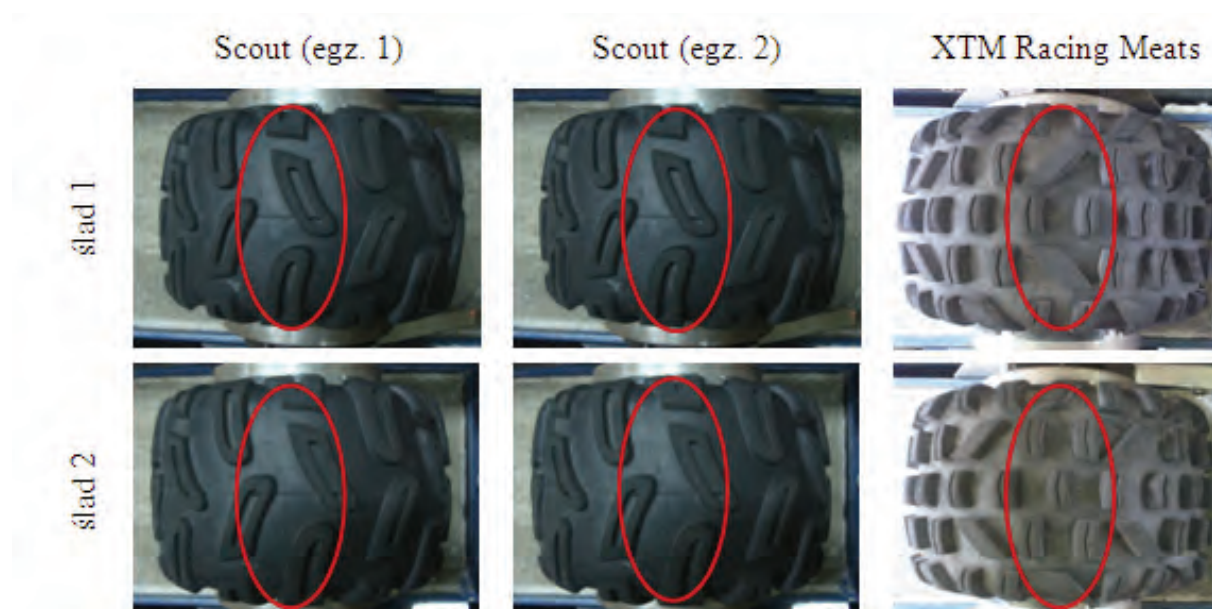
Rys. 2. Badane obiekty i wzory śladów kontaktu opon z podłożem
