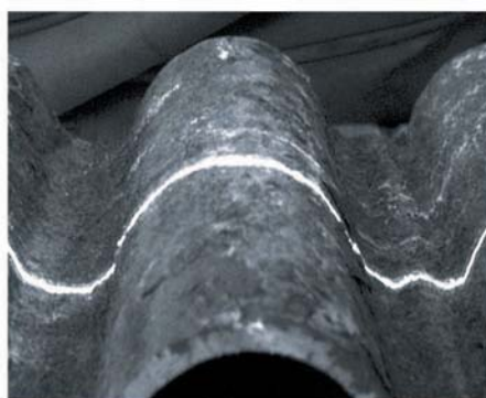
Rys. 10. Skaner laserowy: fotografia liniowej wiązki lasera na powierzchni rur, okno aplikacji komputerowej skanera
