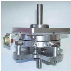
Rys. 4. Czujnik sił i momentów wraz z elementami mocowania do ramienia robota
