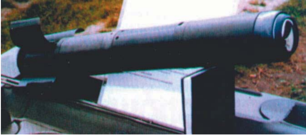
Rys. 6. Moździerzowy pociski z raketowymi silnikami korekcyjnymi 98 mm RAD
