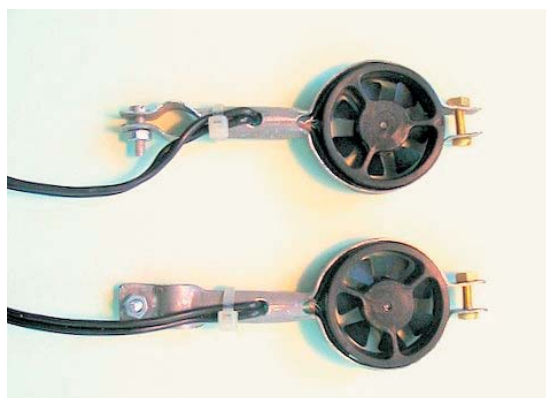
Rys. 2. Turbinki anemometrów zamocowane w oprawkach różniących się kątem zamocowania (0 deg i 90 deg)
