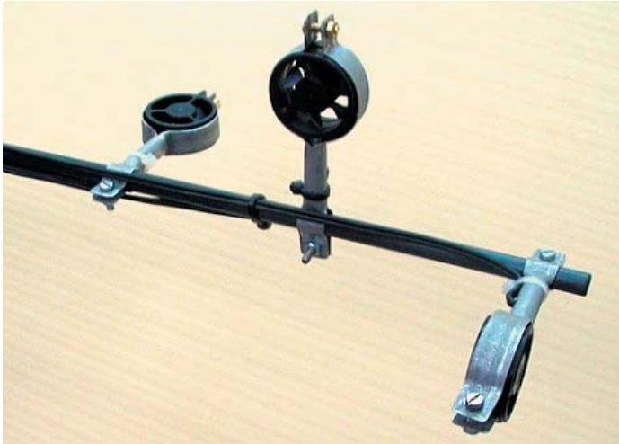
Rys. 3. Trzy anemometry mierzące trzy składowe prędkości powietrza
