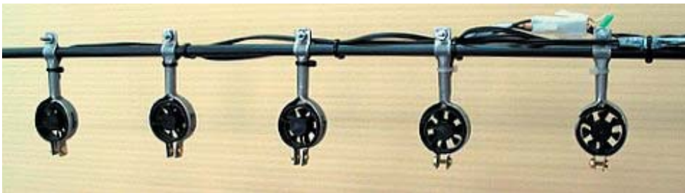
Rys. 4. Anemometry przygotowane do pomiaru profilu przepływu
