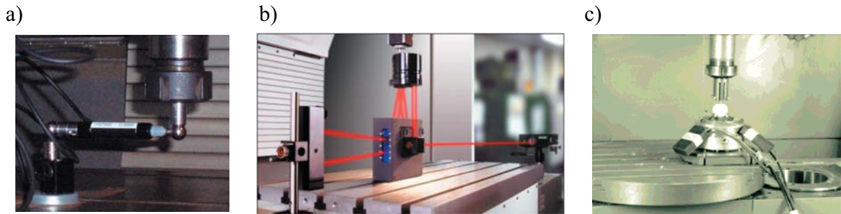
Rys. 1. Urządzenia do badania dokładności obrabiarek NC: komercyjne [3] (a – Ball Bar Renishaw, b – interferometr laserowy Renishaw z układem optycznym do badania prostokątności osi liniowych) i testowane w laboratoriach [4] (c – R-test).
