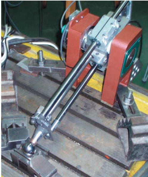
Rys. 4. Sprawdzenie dokładności pomiaru kąta i promienia VB z wykorzystaniem pryzmy: a – budowa stanowiska pomiarowego, b – wyniki pomiaru kąta, c – wyniki pomiaru promienia
