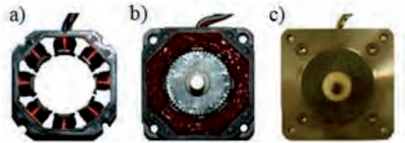
Rys. 6. Budowa hamulca MR: a) widok cewek, b) wnętrze hamulca, c) widok zewnętrzny Fig. 6. Construction of MR Brake: a) view of the coils, b) the interior of the brake, c) exterior view
