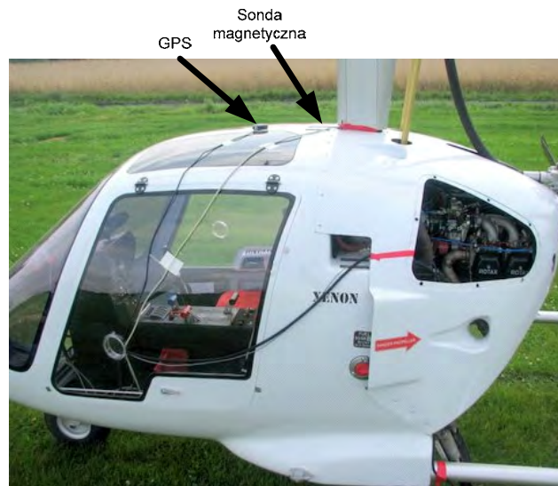
Rys. 9. Rozmieszczenie sondy magnetycznej oraz anteny GPS Fig. 9. GPS and magnetometer mount positions
