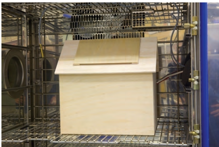
Rys. 1. Obiekt regulacji – model budynku ogrzewanego żarówkami
