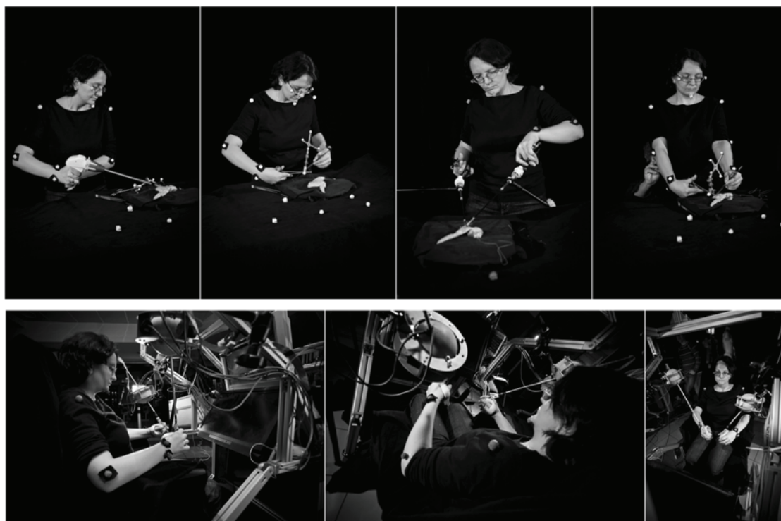
Rys. 2. Badania ergonomii pracy chirurga i operatora robota chirurgicznego. U góry – sterowanie ruchem głowy robotem Robin Heart Vision ((Z. Nawrat) i charakterystyki przemieszczeń kątowych ruchu głowy w płaszczyźnie poziomej [6]. Poniżej badania pracy chirurga (J. Śliwka Śląskie Centrum Chorób Serca) – trajektoria punktu A końcówki narzędzia [8]. Poniżej – kolejne badania wykonane w FRK podczas pracy chirurga operującego klasycznie oraz za pomocą telemanipulacji robotem Robin Heart z konsoli Robin Heart Shell 2
