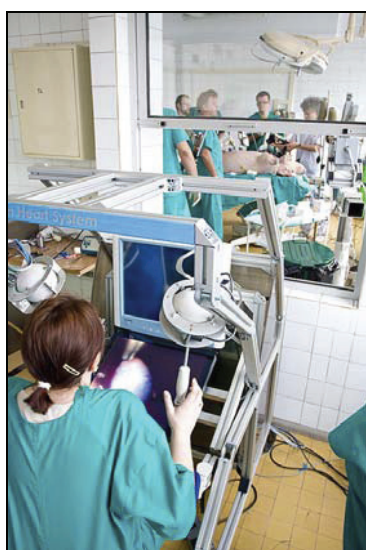
Rys. 1. U góry; chirurg podczas operacji, który stał się inspiracją nowej konsoli oraz operator robota za pomocą konsoli Robin Heart Shell 1, poniżej konsola Robin Heart Shell 2, na dole widok sali operacyjnej ze stycznia 2009 r. i pola operacyjnego podczas eksperymentu w maju 2010 r. (Centrum Medycyny Doświadczalnej, Śląski Uniwersytet Medyczny w Katowicach)
