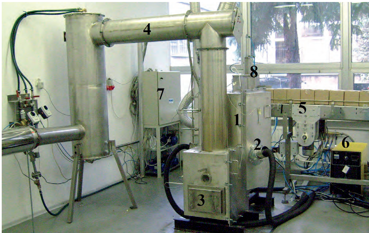
Rys. 1. Widok stanowiska badawczego: 1. Reaktor plazmowy, 2. Plazmotron, 3. Odbiór wytopu, 4. Komin z wyciągiem spalin, 5. Przenośnik porcji odpadów z zasobnikiem liniowym, 6. Moduł zasilania plazmotronu, 7. Szafa PLC – sterowanie i akwizycja danych, 8. Podajnik porcji odpadów do reaktora
