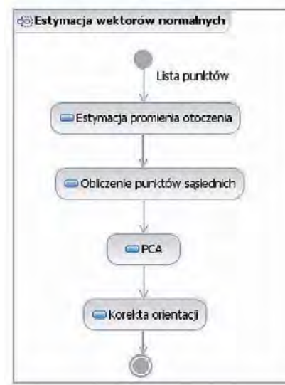
Rys. 4. Schemat algorytmu estymacji kierunków wektorów normalnych
