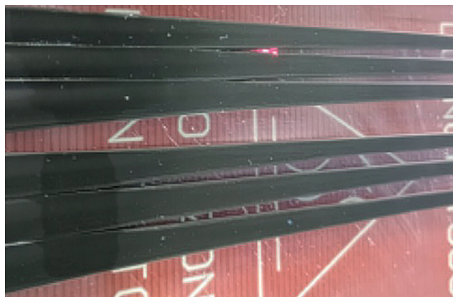
Rys. 14. Widok wydrukowanych ścieżek przy liniowo zmiennym posuwie i różnym rozstawie (opracowanie własne) Fig. 14. View of the printed paths at linearly varying feed rates and different spacings (own work)
