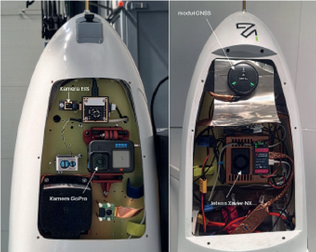
Rys. 3. Z lewej: dolna część kadłuba BSP z zaznaczonymi kamerami, z prawej: górna część kadłuba BSP z zaznaczonym modułem GNSS oraz jednostką obliczeniową [opr. własne] Fig. 3. Left: lower part of the UAV hull with marked cameras, right: upper part of the UAV hull with marked GNSS module and computing unit [own study]
