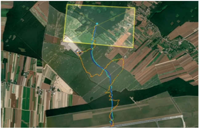
Rys. 2. Wizualizacja estymowanej lokalizacji BSP przez komponent MPC – kolor żółty, GPC – kolor czerwony, FC – kolor cyan, w porównaniu do lokalizacji wyznaczonej przez moduł GNSS – kolor niebieski [opr. własne] Fig. 2. Visualization of the estimated UAV location by the MPC component – yellow, GPC – red, FC – cyan, compared to the location determined by the GNSS module – blue [own study]
