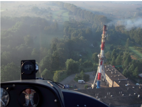
Widok nieruchomej przeszkody (komina) przez przednią szybę śmigłowca w trakcie prób w locie oraz przebieg trasy w czasie serii prób w locie antykolizyjnego układu AURA
