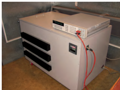
Osiągnięcie projektowe – powietrzny termostat wzorców impedancji. Termostat z wymuszoną cyrkulacją powietrza charakteryzuje się stabilnością temperatury lepszą niż 0.02 °C.
