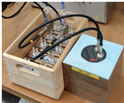
Osiągnięcie projektowe - czteroportowe wzorce rezystancji Vishay. Wzorce, wykalibrowane podczas stażu naukowego w szwajcarskim Krajowym Instytucie Metrologicznym METAS, charakteryzują się współczynnikiem temperaturowym 0.05 ppm/°C. Zostały wykorzystane w KMEiA i w GUM do walidacji cyfrowego komparatora impedancji.
