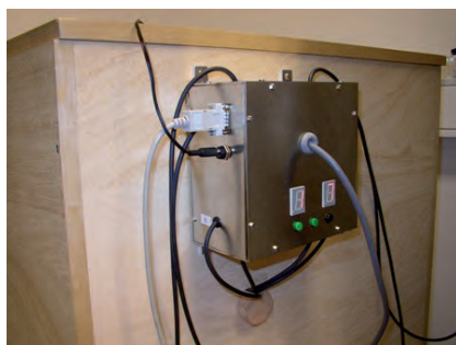
Osiągnięcie projektowe – precyzyjny multiplekser wzorców indukcyjności własnej. Wdrożony do stosowania na stanowisku wzorca państwowego w Physikalisch-Technische Bundesanstalt w Brunshwiku (Niemcy)
