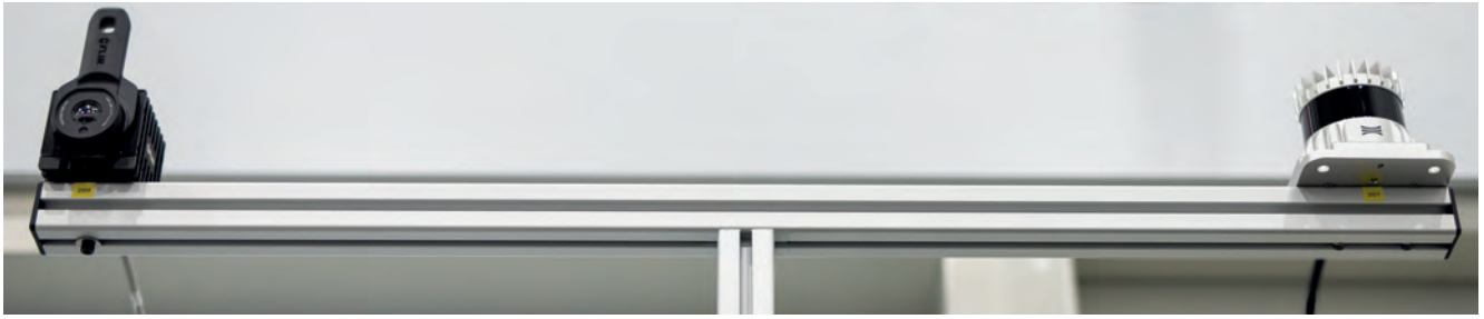
Fig. 12. Thermal imaging camera (left) and LiDAR system (right) Rys. 12. Kamera termowizyjna (po lewej) oraz system LiDAR (po prawej)
